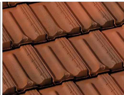
Tuile mécanique traditionnelle, à côte, (13 à 20 tuiles/m 2 ). Dimensions courantes 21,5/35cm
