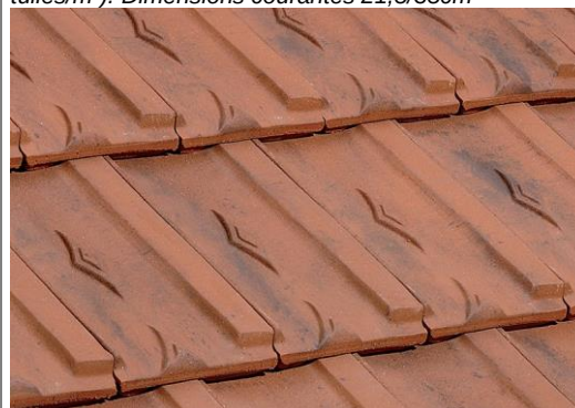
Tuile mécanique traditionnelle, losangée (13 à 20 tuiles/m 2 ). Dimensions courantes 21,5/35cm
