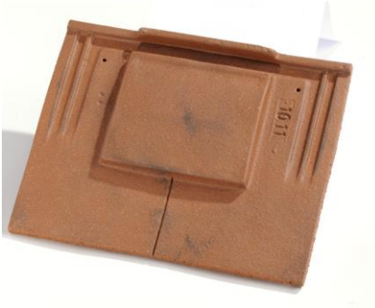
Tuile néoplate à emboîtement, rectangulaire, Petit moule : dimensions courantes 27/35cm, 20 tuiles/m 2
