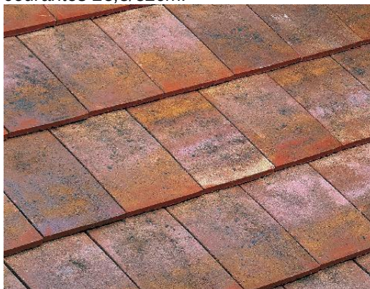
Tuiles plates à emboîtement, à petit moule, rectangulaires (22 tuiles/m²). Dimensions courantes 23,5/32cm
