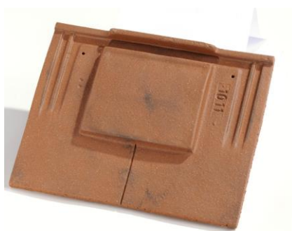
Tuile néoplate à emboîtement, rectangulaire, Petit moule : dimensions courantes 27/35cm, 20 tuiles/m 2
