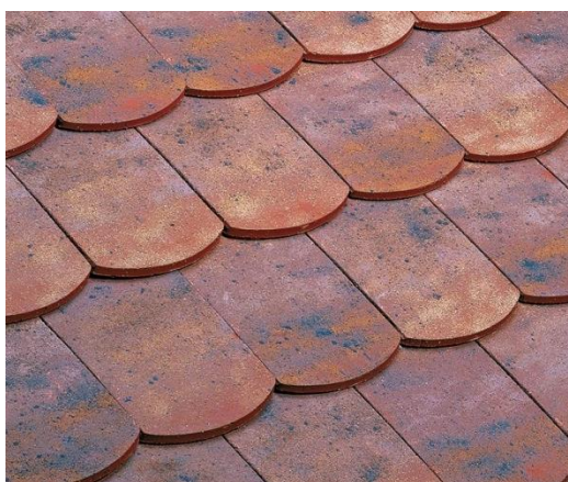
Tuiles plates à emboîtement, à petit moule, écailles (22 tuiles/m²). Dimensions courantes 23,5/32cm.
