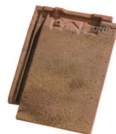
Tuile plate à emboîtement, rectangulaire Petit moule : dimensions courantes 23,5/32cm, 22 tuiles/m 2
